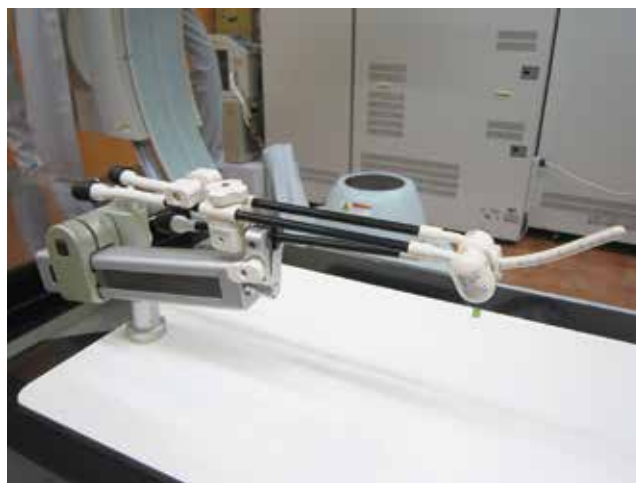
図2：アーチファクト軽減、MRI対応のため非金属製のアプリーケーターを使用
